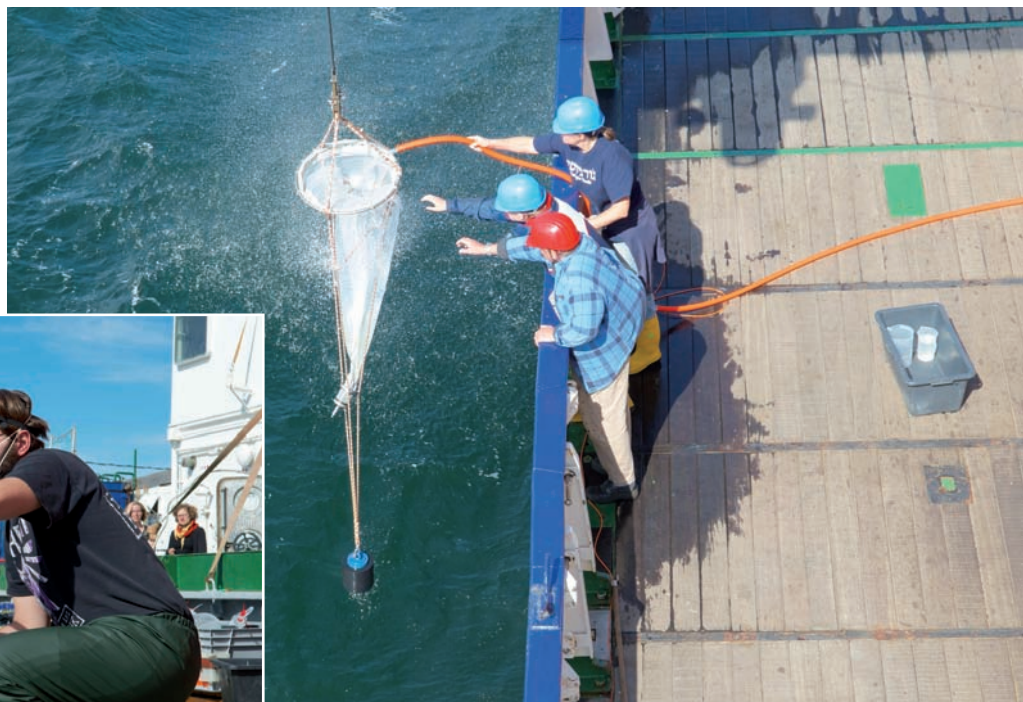
Kleines Foto: Paul Dlugosch von der Uni Rostock entnimmt Wasser aus dem am IOW entwickelten AFIS-Probennehmer. Großes Foto: Ein Planktonnetz wird nach dem Einsatz an Bord geholt. Fotos: vdL / IOW
