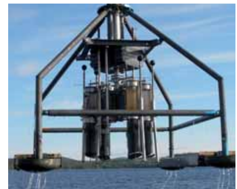
Der Multicorer kann mehrere kurze Kerne gleichzeitig ziehen. Foto: Thomas Leipe, IOW
