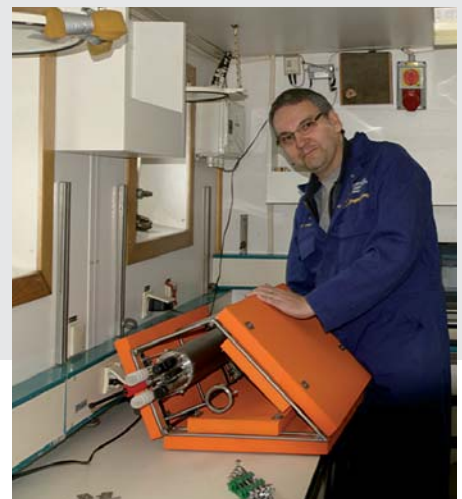
Die neue Messstation für die Gotlandsee mit Bodengewicht, Winde, Auftriebskörpern und dem Herzstück – den Messgeräten. Grafik: Ralf Prien, IOW
