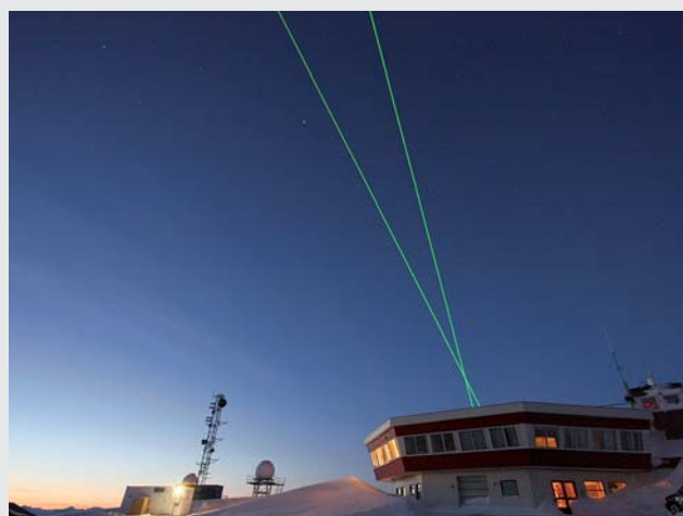
Forschungsstation ALOMAR mit dem mobilen Temperaturlidar des IAP. Dieses befindet sich in einem Container, welcher links vom Gebäude bei der hellen Lampe steht. Auf dem Foto sind nur die grünen Laserstrahlen zu erkennen, da die übrigen Farben für das menschliche Auge nicht sichtbar sind.
