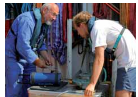
Siegfried Krüger (links) und Erik Stohr bereiten den Einsatz eines „Aqua Guards“ vor, mit dessen Hilfe an den Stationen Messdaten gesammelt und für den Funkversand vorbereitet werden. Foto: R. Labrenz, IOW.
