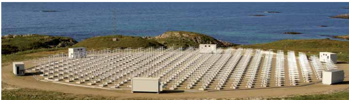
Antennenfeld des neuen Radars als Teil des ALOMAR Observatoriums nahe der Andoya Rocket Range in Andenes, Norwegen (69°N, 16°E). Foto: Ralph Latteck, IAP
