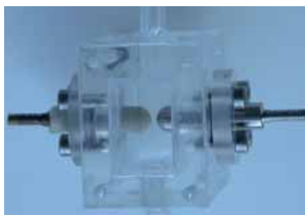
In dieser Entladungszelle wurde die Mikroentladung in Argon gezündet. Foto: Tomáš Hoder
