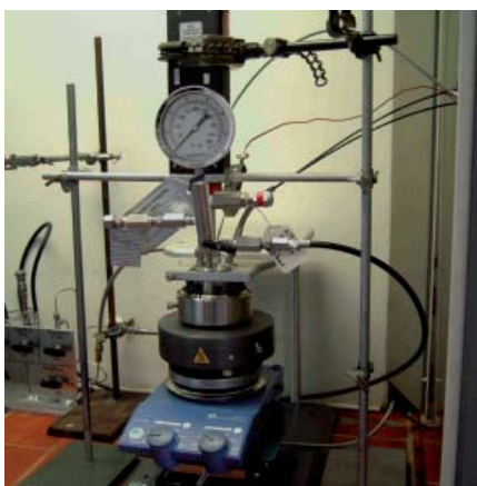
Links: Schema einer Dreifach-Kopplung spektroskopischer Methoden. Sie führt die analytischen Potenziale von UV-Licht (UV-vis), Laser (Raman) und Elektronen (EPR) zusammen. Diese Kopplung zur Analyse von Katalysatoren gelang erstmals in Berlin-Adlershof. Rechts: Raman/ATR/UV-vis-Reaktor für Mehrphasensysteme. Grafik/Foto: LIKAT
