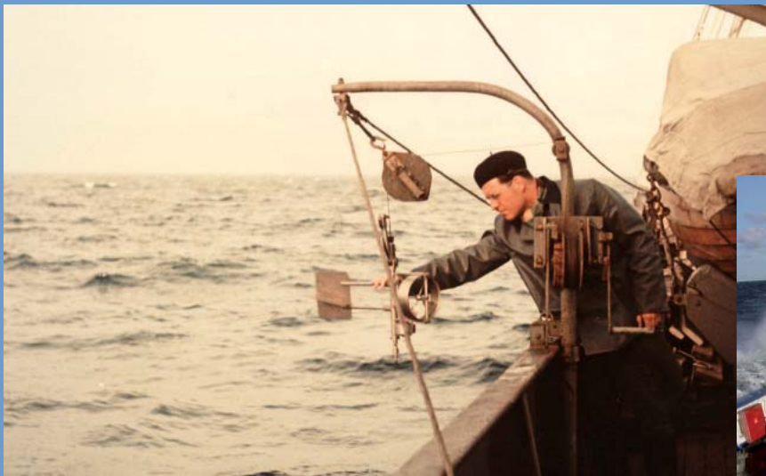
Links: Im Februar 1952 - an Bord des Forschungsschiffes „Joh. L. Krüger“, der späteren „Professor A. Penck“, wird ein Strömungsmesser zum Einsatz gebracht.
