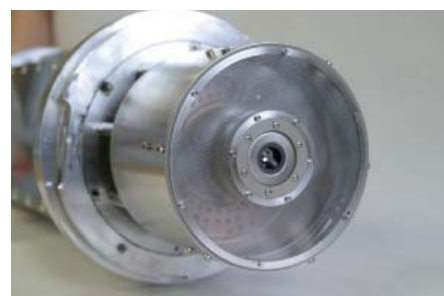
Meteorstaub-Detektor des IAP. In der Mitte deutlich zu sehen: die Xenon-Blitzlampe. Nach der Messkampagne fällt der Detektor an einem Fallschirm ins Meer und wird von dort geborgen. Foto: IAP
