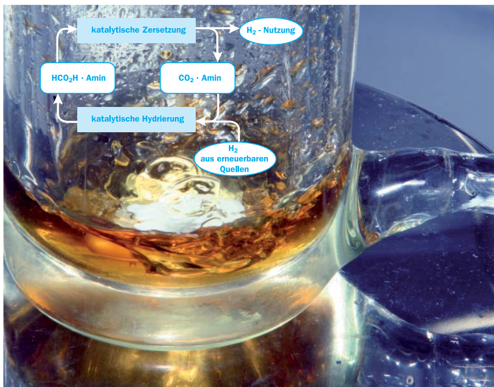
Die Zukunft beginnt im Glasreaktor, hier als Verbindung von Ameisensäure mit einem herkömmlichen Katalysator. Am LIKAT gelang es erstmals, auf diese Weise Wasserstoff bei Zimmertemperatur herzustellen.
