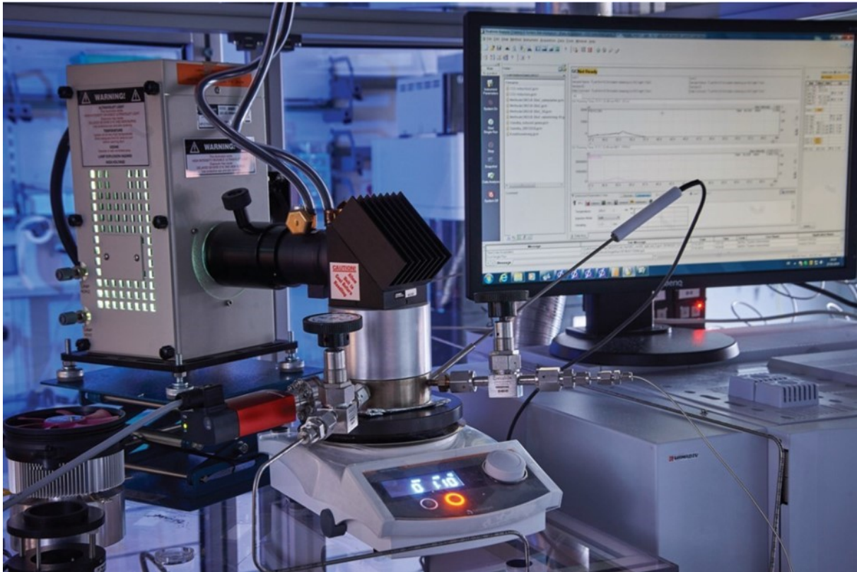
Abb. 1: Photoreaktor im Labor - Unter hochreinen Bedingungen wird durch eine angelegte Lichtquelle (Kasten links) der Photokatalysator im Reaktor aktiviert, so dass das eingeleitete \text{CO}_2 Reaktionen eingehen kann.
