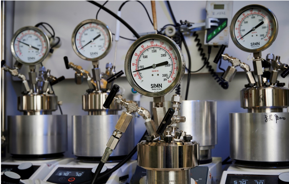
Abb. 1: Methylformiat als Wasserstoffspeicher: In diesen Druckreaktoren untersuchte die Forschergruppe die Freisetzung von Wasserstoff aus einem Methylformiat-Wasser-Gemisch mithilfe eines Ruthenium-Katalysators. Aus dem Druckanstieg lässt sich die Menge des produzierten Wasserstoffgases im Reaktor ablesen. Foto: LIKAT/Nordlicht
