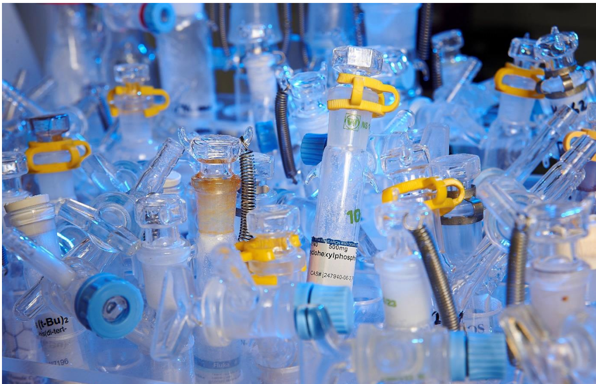
Abb. 1: In sog. Schlenkgefäßen werden neue luft- und wasserempfindliche Katalysatoren unter Schutzgasatmosphäre hergestellt und gelagert. (Foto: LIKAT/Nordlicht)
