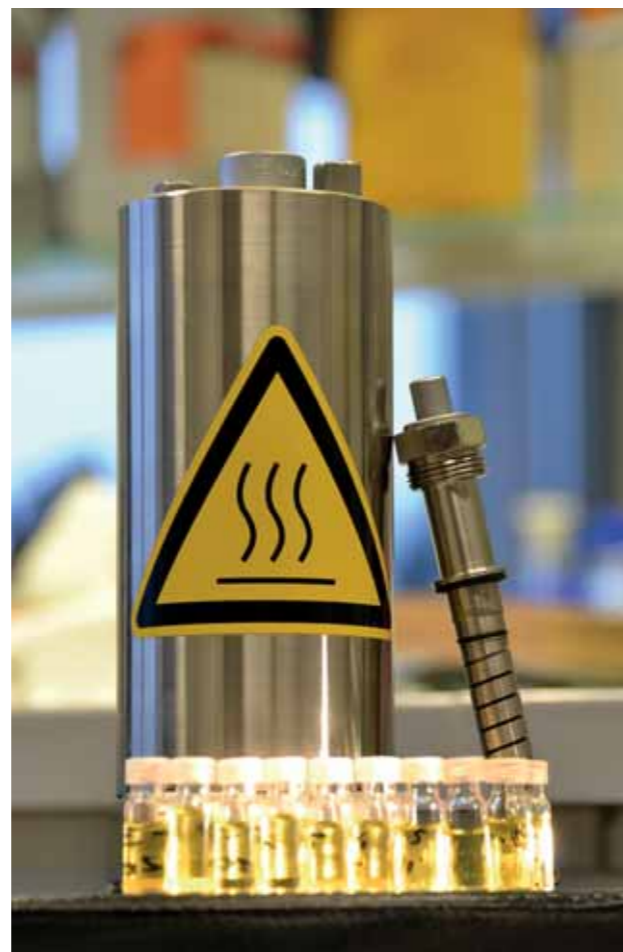
Figure 2. Kartuschenreaktor der Ehrfeld Mikrotechnik BTS für heterogen kataly- sierte Mehrphasenreaktionen
