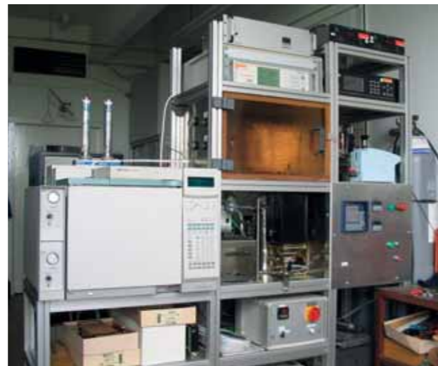
Testanlage zur Untersuchung von DeNO x -Katalysatoren im Festbettreaktor
