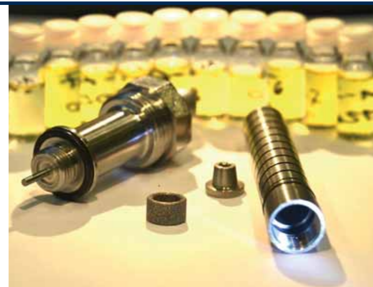
Figure 3. Zylinderförmige Kartusche zur Befüllung mit heterogenen Katalysatoren
