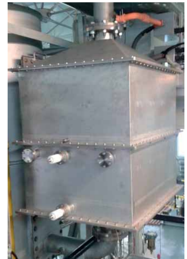
Testreaktor mit 1,2 kg Katalysator auf Wabenkörpern
