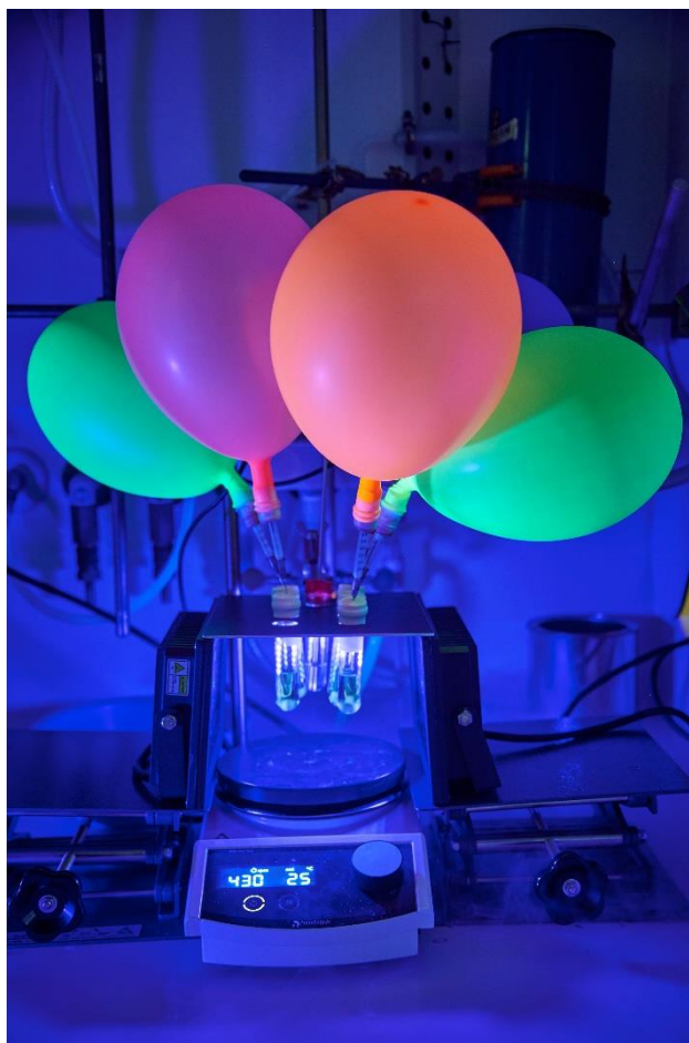
Abb. 2: „Anfangs nahmen wir einfach Luftballons, bliesen sie im Labor auf und stülpten sie über die Apparatur.“ – Experiment mit Gaseintrag ins Reaktionsgefäß. (Nordlicht/LIKAT)
