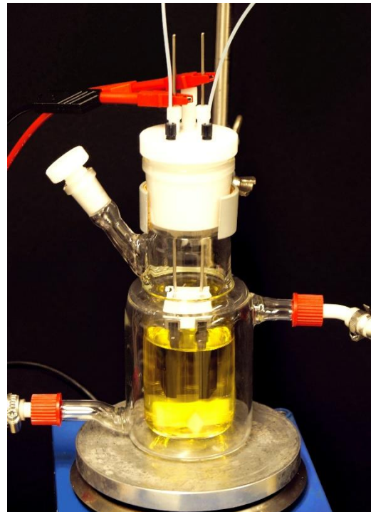
Ein Versuchsaufbau, wie er in der präparativen Elektrochemie üblich ist: Zwischen zwei Elektroden wird eine Spannung angelegt, welche die elektrochemischen Reaktionen ermöglichen. Im linken Bild stecken Kathode und Anode in einem durch einen Separator geteilten Reaktionsgefäß („geteilte Zelle“), wohingegen sich im rechten Bild beide Elektroden in einem einzigen Gefäß befinden („ungeteilte Zelle“). Fotos: LIKAT/Francke
