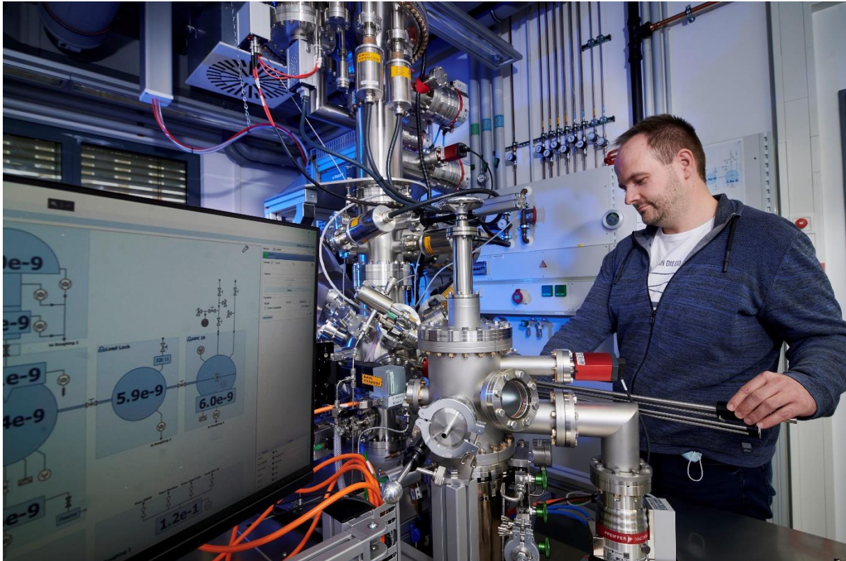
Abb. 1: Dr. Stephan Bartling bereitet das neue NAP-XPS für eine Messung vor. (Foto: LIKAT/Nordlicht)
