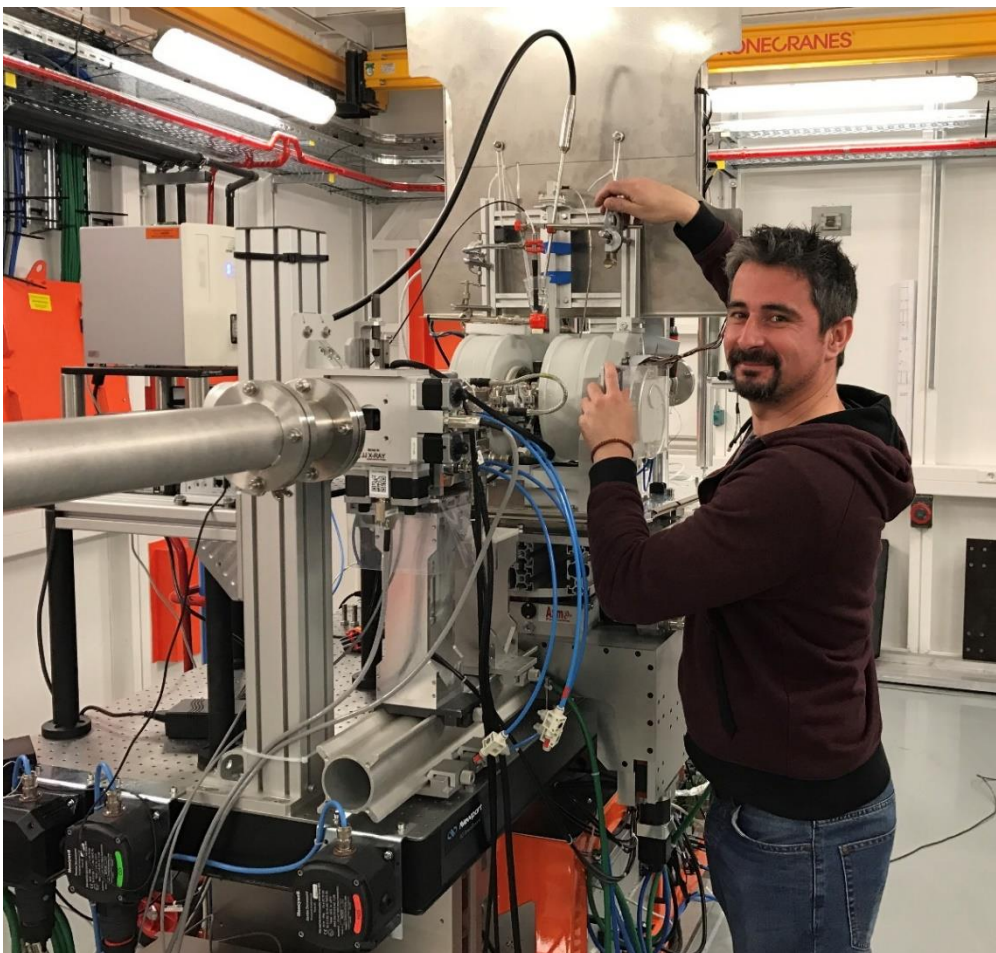
Abb. 2: Laurent Barthe am Synchrotron SOLEIL; der gesamte Versuchsaufbau wurde so modifiziert, dass er in den Röntgenstrahl am Synchrotron in Saint-Aubin (Frankreich) eingebracht werden konnte.
