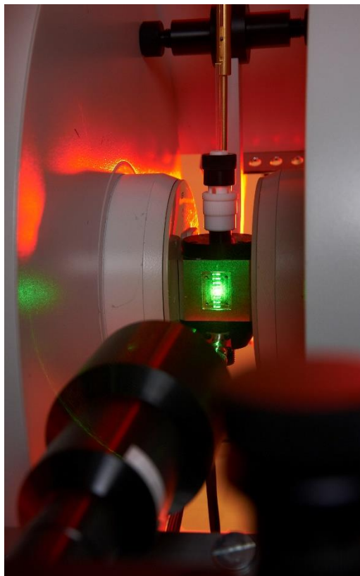
Abb. 1: Blick in ein EPR-Spektroskop im Forschungsbereich „Katalytische In situ-Studien“ von Prof. Angelika Brückner.
