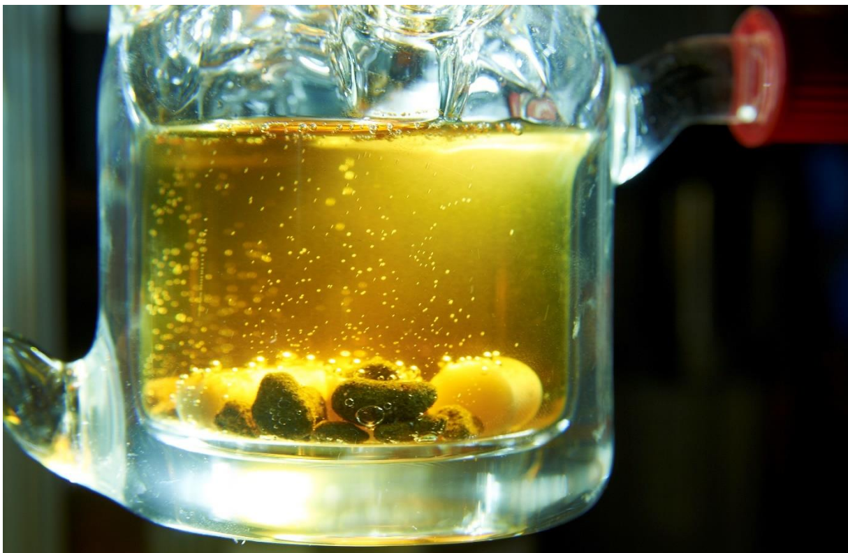
Abb. 2: Mechanistische Untersuchungen finden im Labormaßstab statt; Wasserstofffreisetzung an immobilisierten Katalysator im Reaktor.
