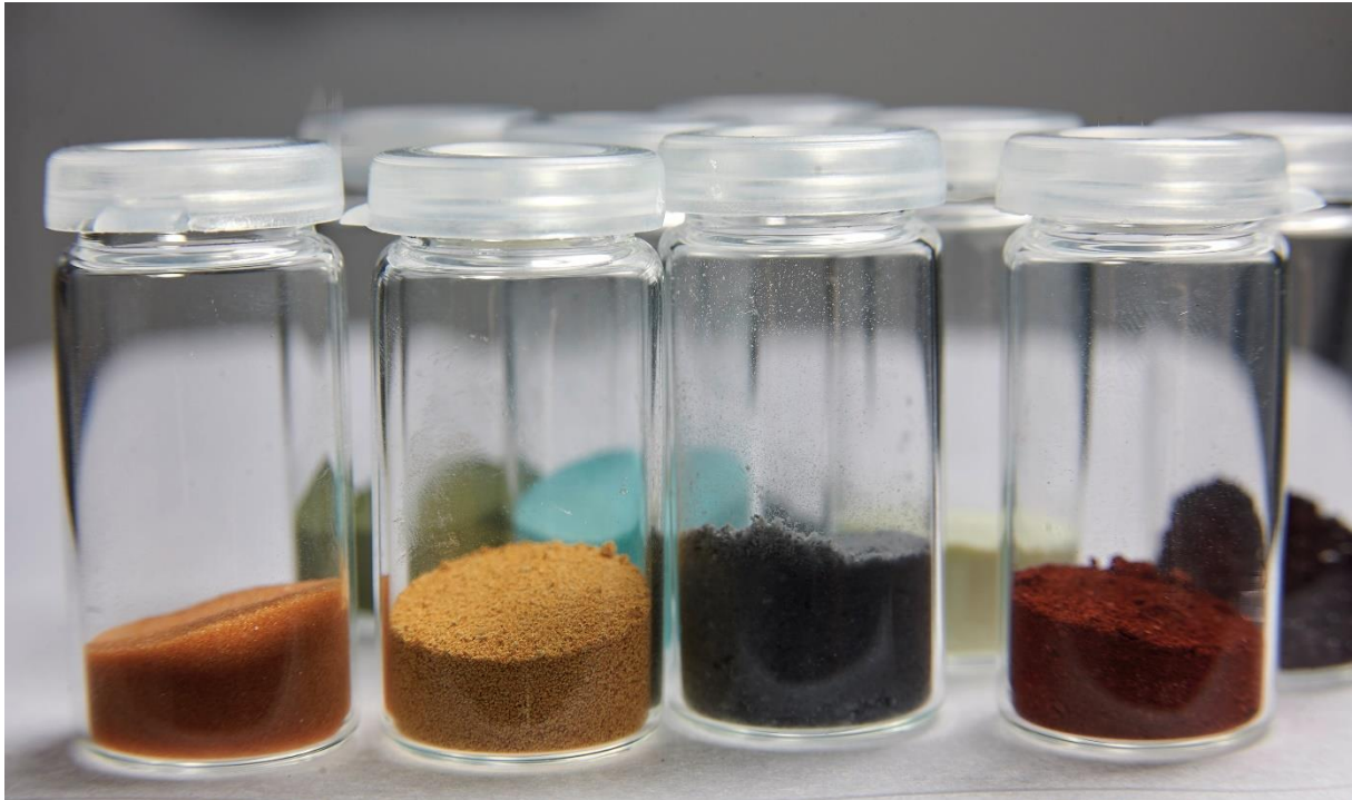
Abb. 1: Heterogene Katalysatoren werden oft in Pulverform eingesetzt. Nach der Reaktion kann dieses dann zu Boden sinken, was die Abtrennung des Katalysators stark vereinfacht.
