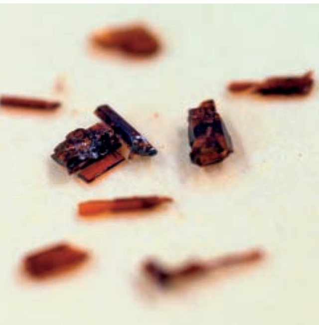
Kleinste Mengen eines Katalysators können die Reaktion zwischen zwei Stoffen stark beschleunigen. Hier Kristalle eines Kobalt-Katalysators
